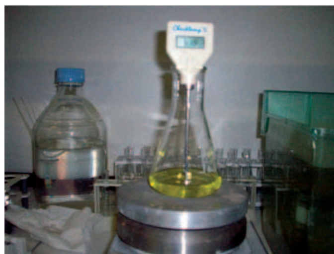
Figura 2 - Allontanamento dell'esano per riscaldamento a 60 °C.
