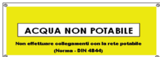
Figura 2 - Etichetta Norma DIN 4844 recante dicitura "Acqua non potabile".
