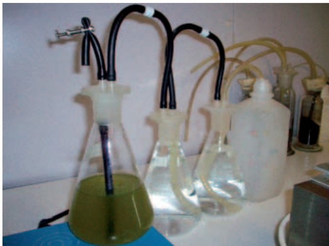
Figura 4 - Apparato sperimentale per la produzione di bioH 2 e bioCH 4 .
